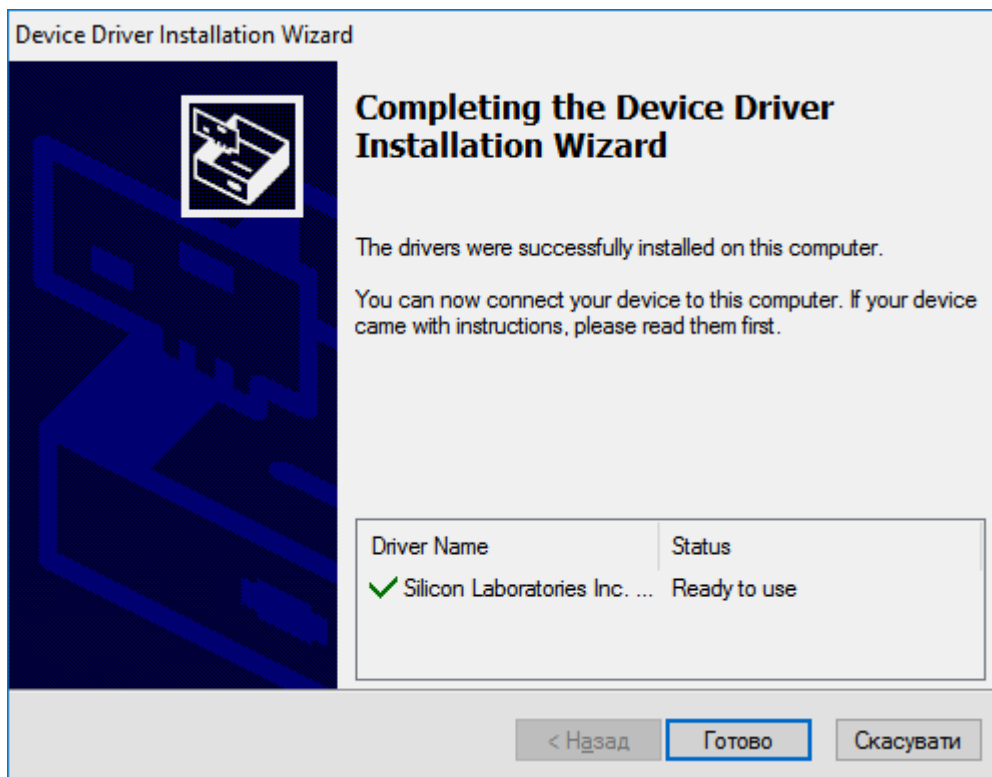
Рис. 4.5. Успішне встановлення драйвера CP2102
