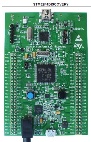
Рис. 2.5. Світлодіоди на відлагоджувальній платі
