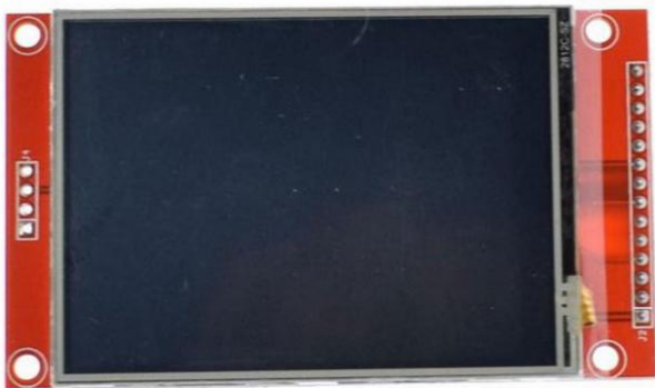
Рис. 2.31. Кольоровий графічний індикатор ILI9341. Вид з фронтальної сторони
