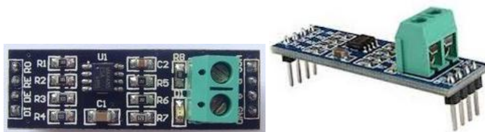
Рис. 5.44. Зовнішній вигляд вузла RS-485 лабораторного стенду
