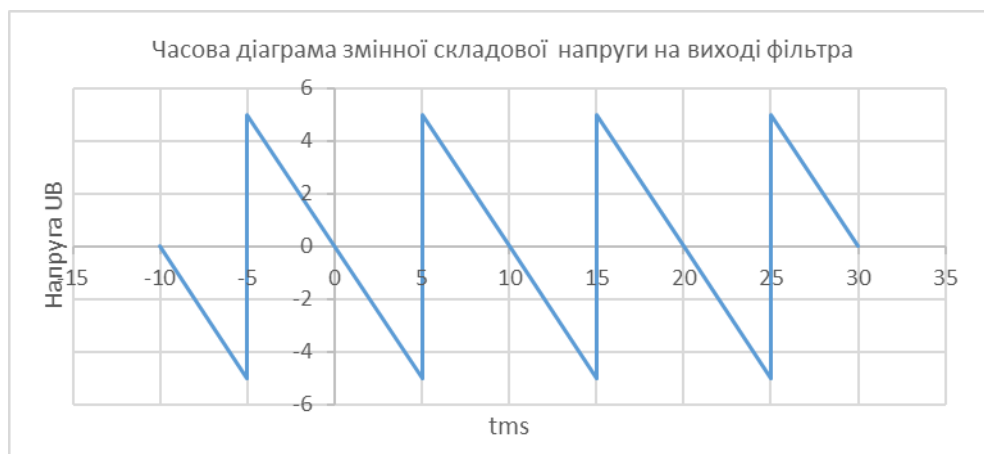
Рис. 5. Часова діаграма змінної складової напруги на виході фільтра.
